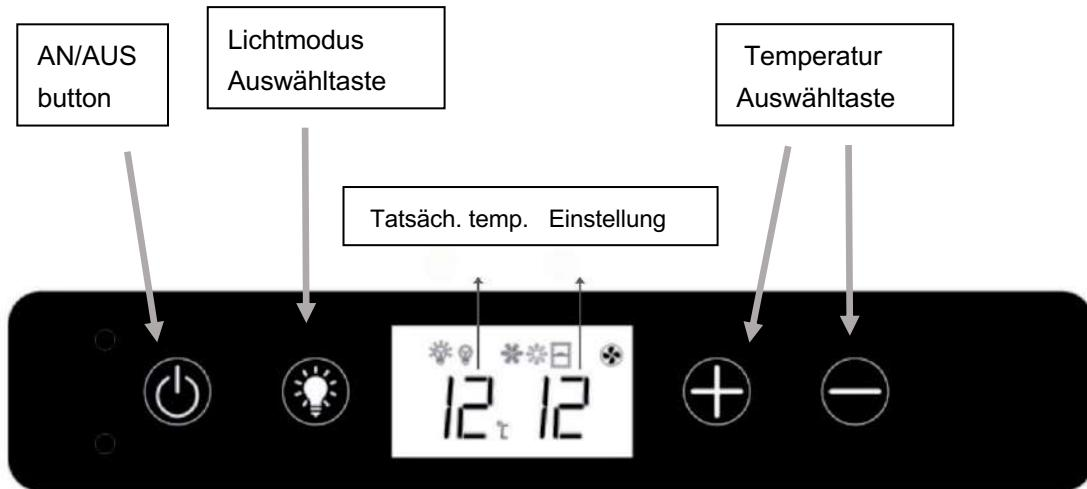
Der Temperaturbereich für die linke Zone & die rechte Zone ist in beiden Fällen 5-20°C.
