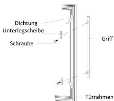
2. Gleichen Sie den Griff den Schrauben an und ziehen Sie die Schrauben an, bis der Griff bündig und sicher an dem Türrahmen befestigt ist (Überziehen Sie diese NICHT, da dies die Griff-Baugruppe und die Glasfläche der Tür beschädigen könnte).
