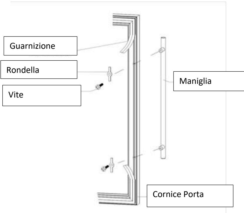
2. Allineare la maniglia con le viti e serrare le viti finché la maniglia non è a filo e fissata saldamente contro il telaio della porta (NON serrare eccessivamente poiché ciò danneggierebbe il gruppo maniglia e la superficie del vetro della porta).
