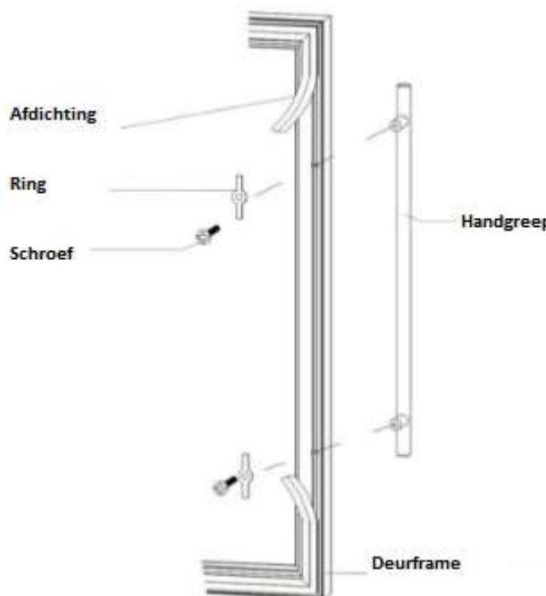
2. Lijn de handgreep uit met de schroeven en schroef de schroeven aan tot de handgreep goed stevig aan het deurframe zit (NIET te strak aandraaien omdat dit de handgreep en de glazen deur kan beschadigen)
