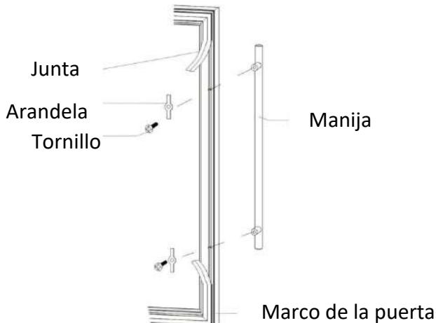
2. Alinee la manija con los tornillos y apriete los tornillos hasta que la manija esté nivelada y asegurada firmemente contra el marco de la puerta. No apriete demasiado, ya que esto dañará el ensamblaje de la manija y la superficie del vidrio de la puerta.
