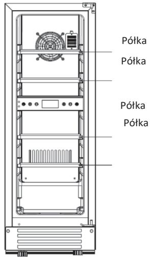
To urządzenie jest wyposażone w elektroniczny termostat i umożliwia regulację temperatury w zakresie od 5 do 20 stopni. W przypadku przechowywania wina zaleca się ustawienie urządzenia na 12 stopni. Temperaturę tę można dostosować do rodzaju przechowywanego wina.
