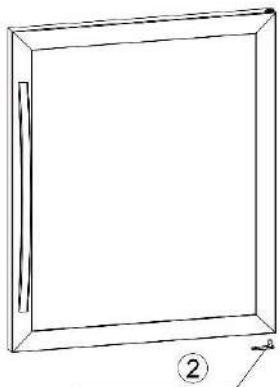
3. retirar a dobradiça superior direita, desapertando os três parafusos.
