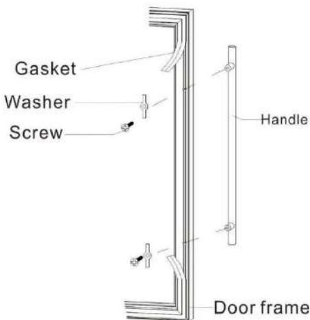
2. Wyrównaj uchwyt ze śrubami i dokręć śruby, aż uchwyt zostanie wyrównany i mocno przymocowany do ramy drzwi (NIE dokręcaj zbyt mocno, ponieważ spowoduje to uszkodzenie zespołu uchwytu i powierzchni szyby drzwi).
