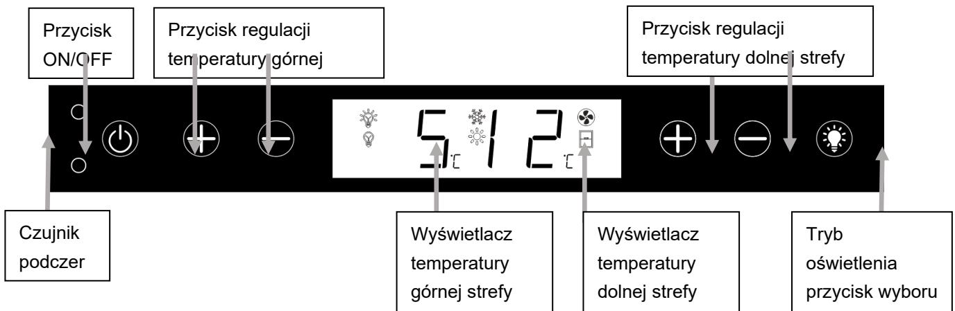
To urządzenie jest wyposażone w czujnik podczerwieni, aby uniknąć nieprawidłowego działania alarmu otwarcia drzwi, nie
