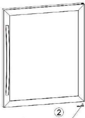
3. Entfernen Sie das rechte obere Scharnier, indem Sie drei Schrauben herausdrehen.
