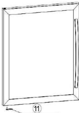
12. colocar a porta no eixo da dobradiça superior esquerda, alinhar a porta com a dobradiça inferior e fixar o eixo da porta na dobradiça inferior esquerda.
