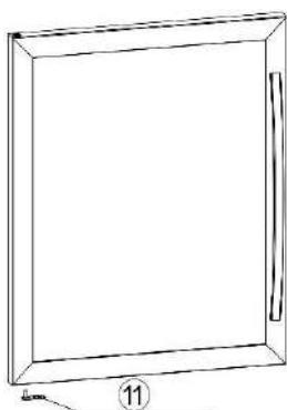
12. Setzen Sie die Tür in die linke obere Türachse ein, passen Sie die Tür dem unteren Scharnier an, und befestigen Sie die Türschse an dem linken unteren Scharnier.
