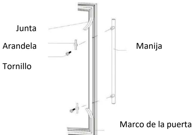
2. Alinee la manija con los tornillos y apriete los tornillos hasta que la manija esté nivelada y asegurada firmemente contra el marco de la puerta. No apriete demasiado, ya que esto dañará el ensamblaje de la manija y la superficie del vidrio de la puerta.
