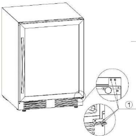
2. Wyjąć oś drzwi z otworu osi drzwi w lewym dolnym rogu drzwi.
