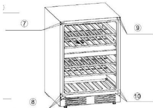
11.Tournez la porte de 180° et insérez l'axe de la porte dans le trou inférieur de l'axe de la porte.
