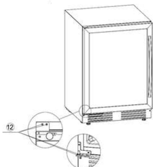
11.Ruotare la porta di 180° e inserire l'asse della porta nel foro dell'asse inferiore della porta.
