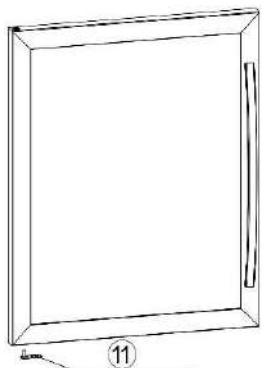
12.Plaats de deur in het scharnier linksboven, stel de deur af met het onderste scharnier en zet de as vast.
