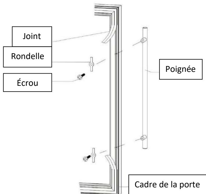
2. Alignez la poignée avec les vis et serrez-les jusqu'à ce que la poignée soit à la fois affleurante et fermement fixée contre le cadre de la porte (NE PAS trop serrer car cela endommagerait l'assemblage de la poignée et la surface vitrée de la porte).
