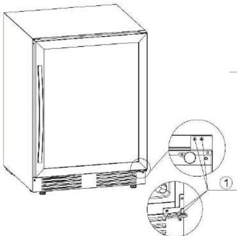
2.Verwijder de as door deze uit het gat te halen linksonder in de deur.
