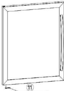
12. Umieścić drzwi w osi lewego górnego zawiasu, wyrównać drzwi z dolnym zawiasem i przymocować osi drzwi do lewego dolnego zawiasu.
