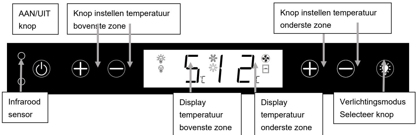
Dit apparaat is voorzien infraroodsensor, om storingen bij het open-deur-alarm te vermijden niet het apparaat onder fel licht, buiten of in zonlicht zetten.
