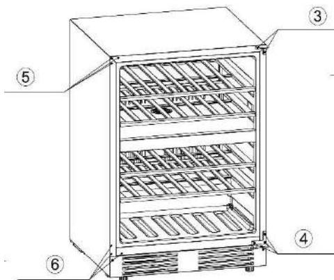
7. Montieren Sie das linke obere Scharnier
