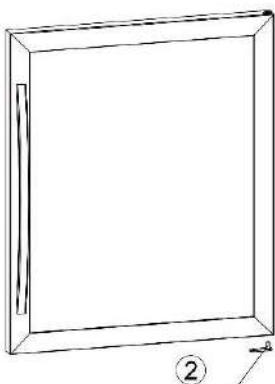
3.Verwijder het scharnier rechtsboven door drie schroeven los te schroeven.
