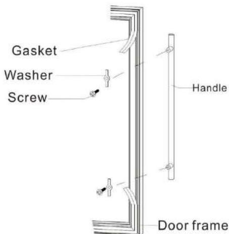
2. Alinhe o manípulo com os parafusos e aperte os parafusos até que o manípulo fique nivelado e bem fixo contra a moldura da porta (NÃO aperte demasiado, pois isso causará danos no conjunto do manípulo e na superfície do vidro da porta).
