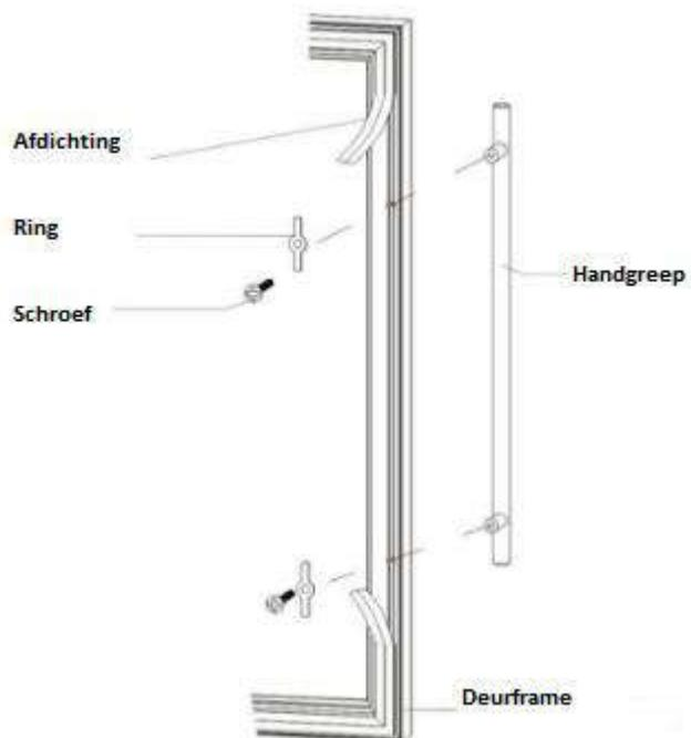
2. Lijn de handgreet uit met de schroeven en schroef de schroeven aan tot de handgreet goed stevig aan het deurframe zit
