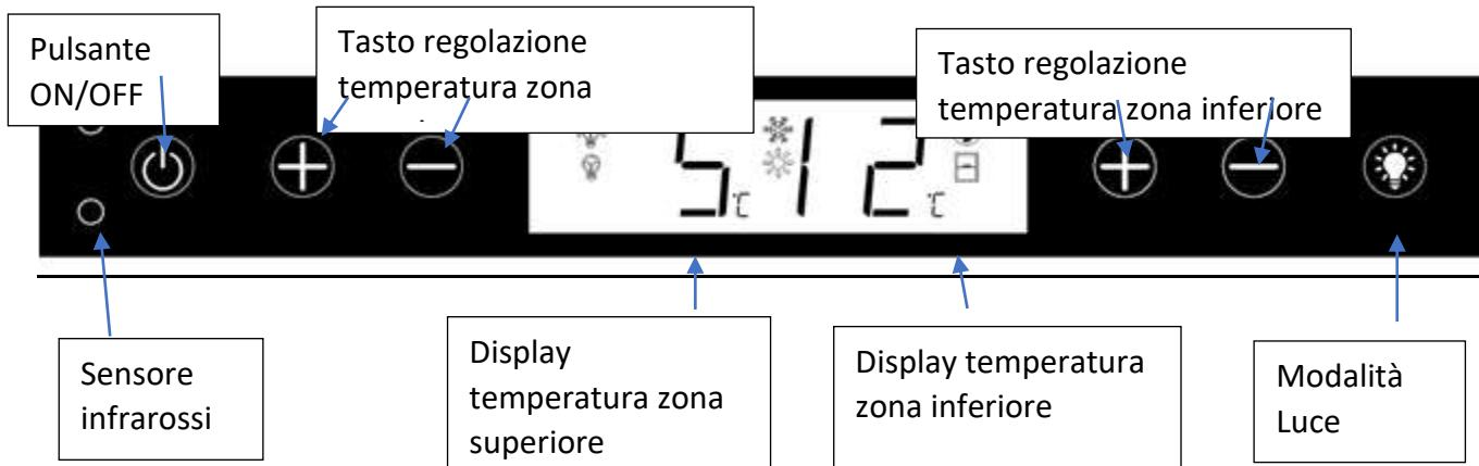
Questo apparecchio è installato con sensore ad infrarossi, per evitare malfunzionamenti dell'allarme porta aperta, non posizionare l'apparecchio in un ambiente emperat, all'aperto o alla luce del sole.
