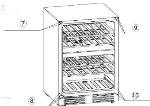
11. Drehen Sie die Tür um 180° und setzen Sie die Türachse in die untere Türachsenöffnung ein.
