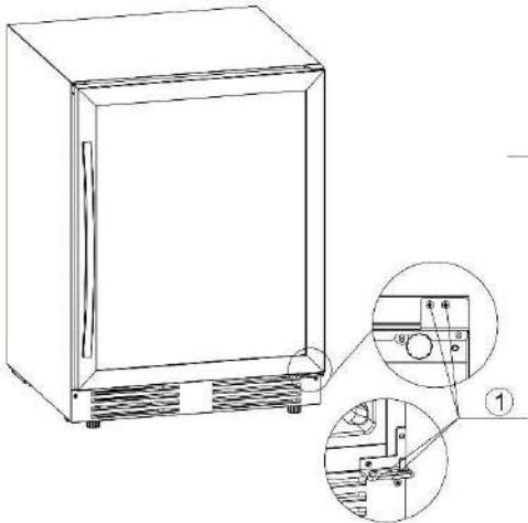
2. retirar o eixo da porta do orifício do eixo da porta na parte inferior esquerda da porta.
