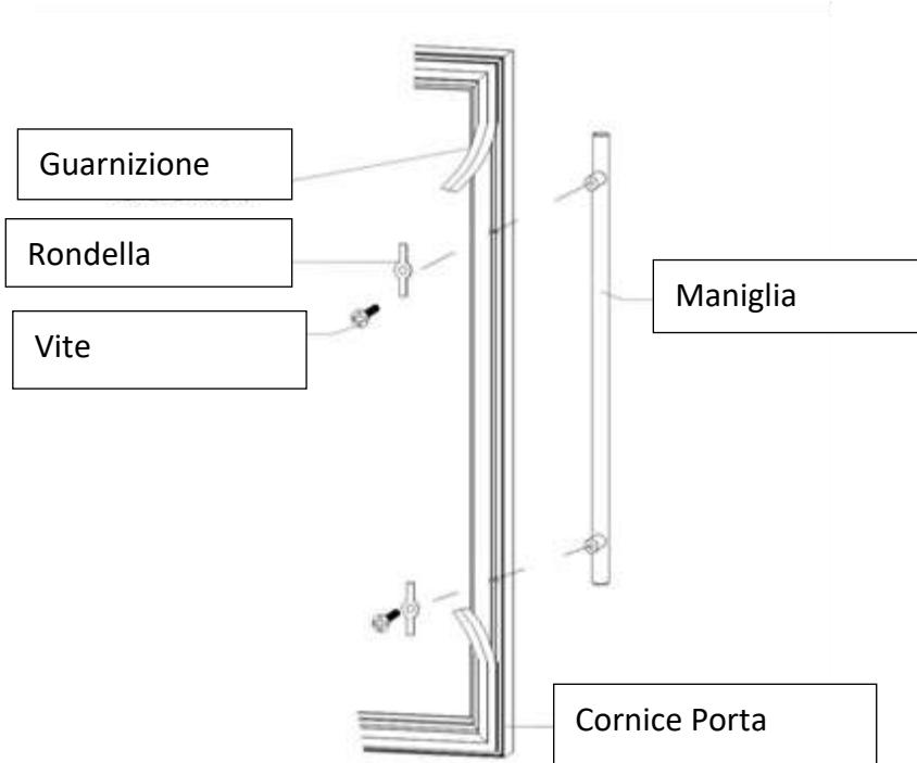
2. Allineare la maniglia con le viti e serrare le viti finché la maniglia non è a filo e fissata saldamente contro il telaio della porta (NON serrare eccessivamente poiché ciò danneggerebbe il gruppo maniglia e la superficie del vetro della porta).
