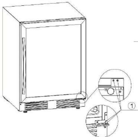
2. Entnehmen Sie die Türachse aus der Türschsenöffnung unten links an der Tür.
