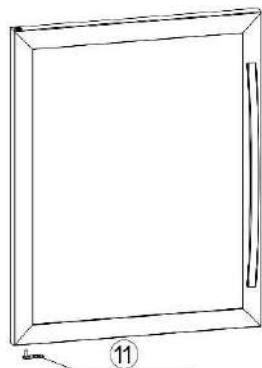
12. Placez la porte dans l'axe de la charnière supérieure gauche, alignez la porte avec la charnière inférieure et fixez l'axe de la porte sur la charnière inférieure gauche.
