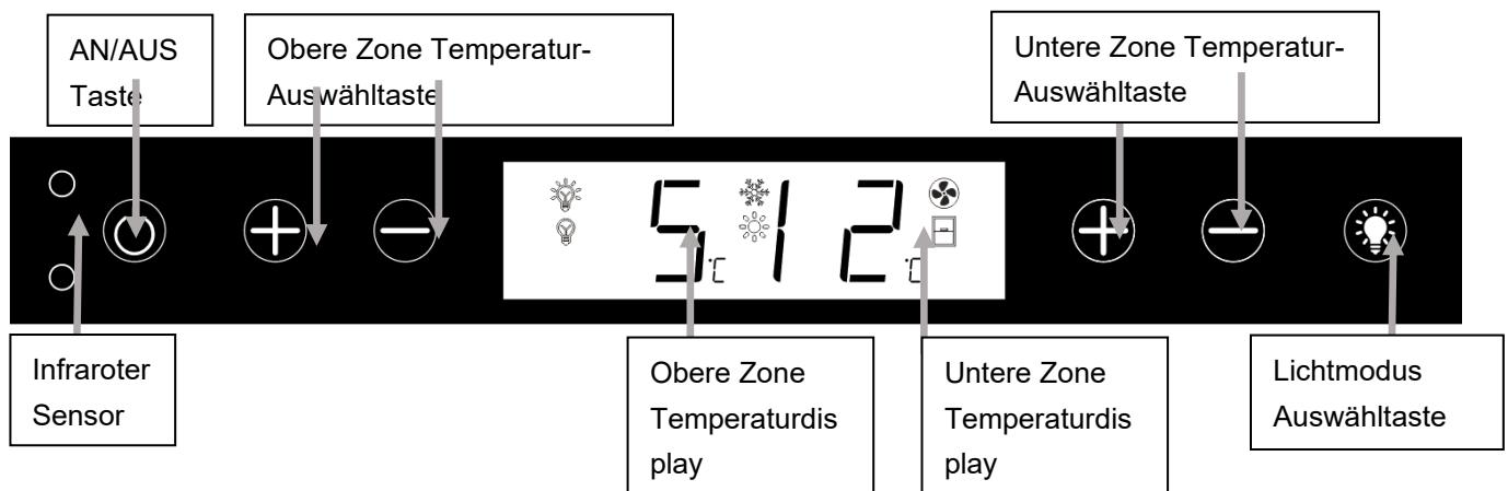
Dieses Gerät ist mit einem infraroten Sensor ausgestattet. Um eine Fehlfunktion von Tür-Offen-Alarm zu vermeiden, platzieren Sie das Gerät nicht in einer hellen Umgebung, draußen oder unter Sonnenlicht.
